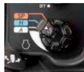
スロットルレバー型モード切替機構 ボリュームを回すだけでスロットルが運動、誰でも簡単に最適な作業性能が選択できます。
